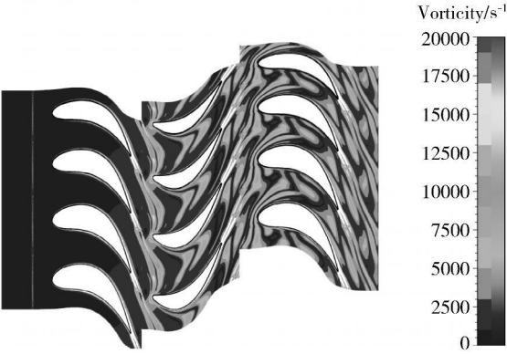
图 7 Clocking 1 位置流动时均涡量值云图 Fig. 7 Time average count of vorticity in Clocking 1 position
